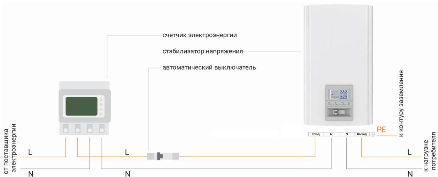
Рисунок 8. Схема подключения Герц к однофазной сети
