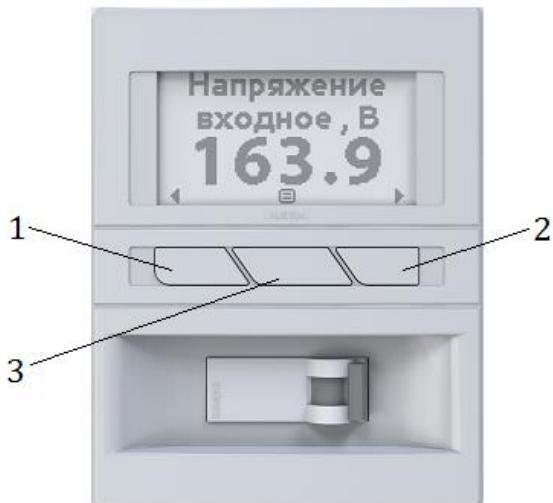
Рисунок 12. Расположение кнопок управления на панели управления Герц V3.0
